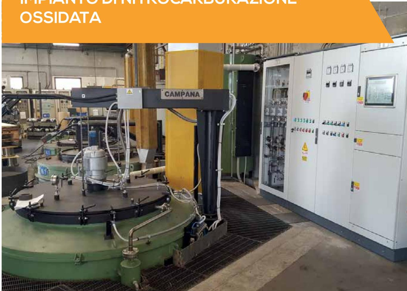
Forno a pozzo verticale per trattamento di nitrurazione, nitrocarburazione pre e post ossidata. Completo di post-combustore, quadro gas con gestione portate a valvole proporzionali, flussimetri a ritrasmissione. Quadro elettrico per gestione forno e touch-panel 15" a supervisione impianto.
