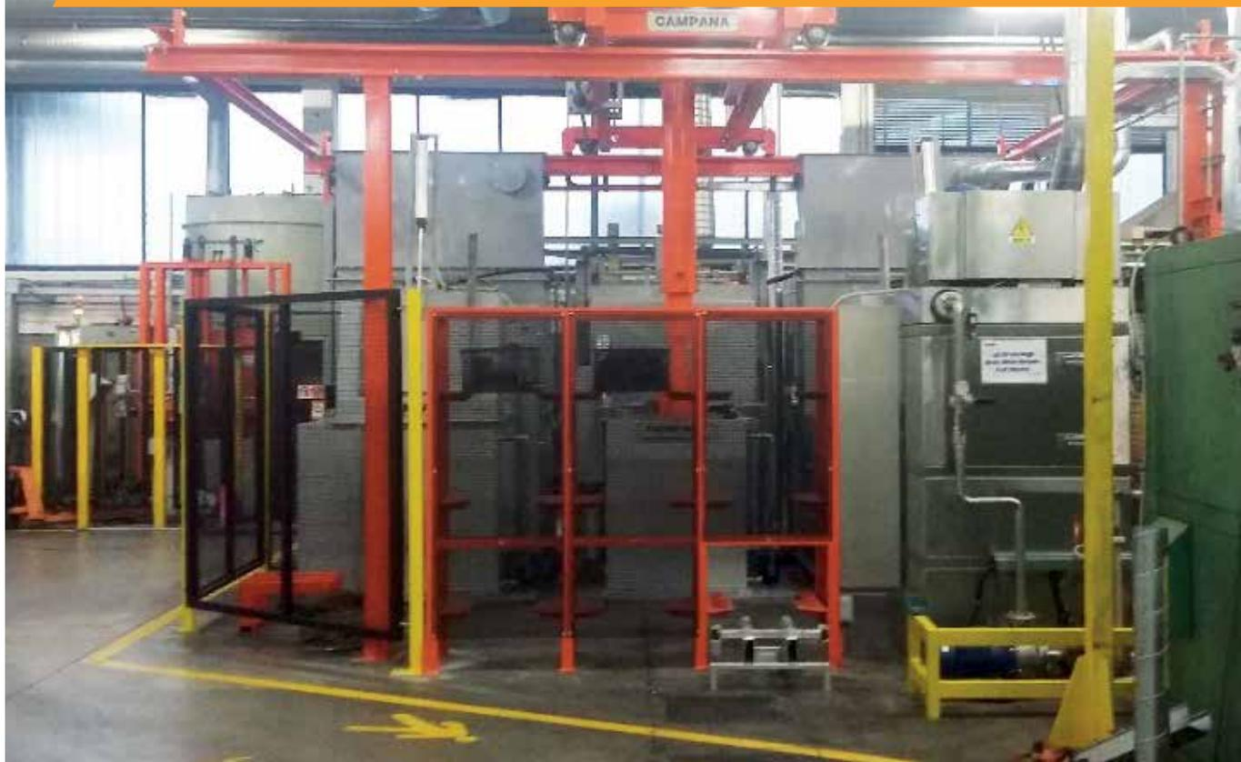
Linea automatica per trattamento di bonifica, solubilizzazione e lavatrice con caricatrice a ponte automatica completa di magazzino a nove postazioni.
