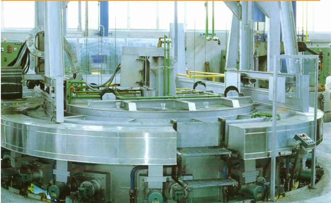
Forno a pozzo per trattamento termico di cementazione con apertura del coperchio automatica e riscaldamento con bruciatori alimentati a metano.
