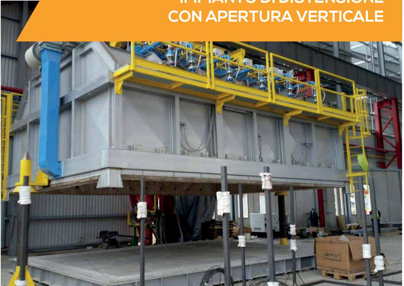
Impianto di distensione lingotti con apertura verticale tramite carroponete, temperatura di lavoro 700 °C con bruciatori autorecuperativi e isolamento in fibra ceramica.
